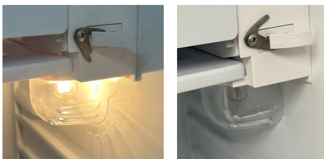
נצרה מכנית שבסגירתה (התמונה מימין) המתג מוחזק גם כשהדלת פתוחה, ולכן האור כבוי.
